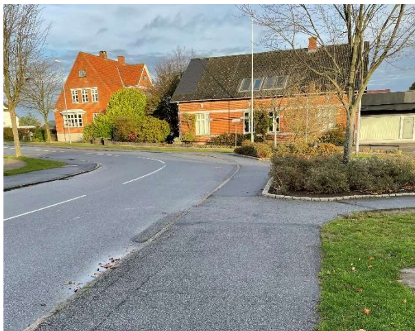
Figur 16 - Vandlingvej, manglende opdeling af ligeudkørende og højresvingende cyklister.
